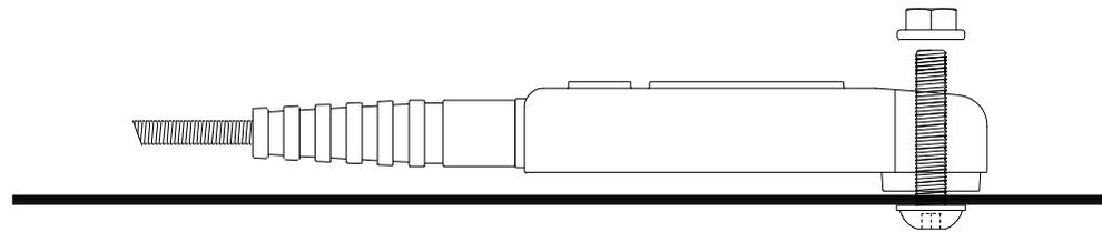
\_\_\_\_\_ Lors de l'installation, prenez soin d'éloigner le plus possible, le câble de ce capteur des autres câbles, principalement de type : RPM, câbles haute tension du système d'allumage, pour éviter les interférences réciproques.
