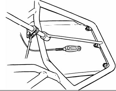
il est conseillé de placer le capteur de champ magnétique avant le capteur de vitesse de manière à recevoir en premier l'impulsion provenant du champ magnétique du circuit.
