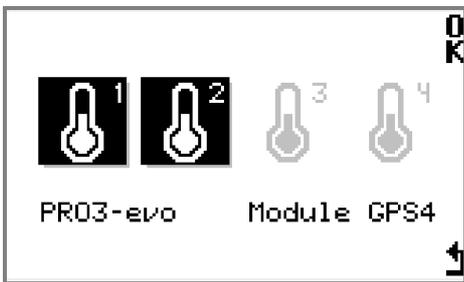
Sélectionner les températures à contrôler T1 et T2 pour le PROIII EVO T3 et T4 (uniquement avec module GPS4)
