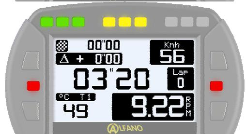
Dès la détection de la bande magnétique, l'affichage de course « Layout » remplace la fenêtre « ACCUEIL », l'ALFANO commence le chronométrage et enregistre les données de ces capteurs.
