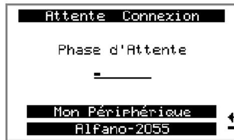
Pressez « OK » sur « Recevoir » dans le menu circuits. L'ALFANO est en attente de connexion.
