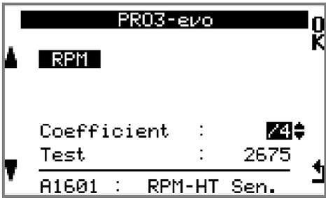
Pressez « **OK** » pour modifier le coefficient de multiplication du RPM, dépendant du type de moteur :
