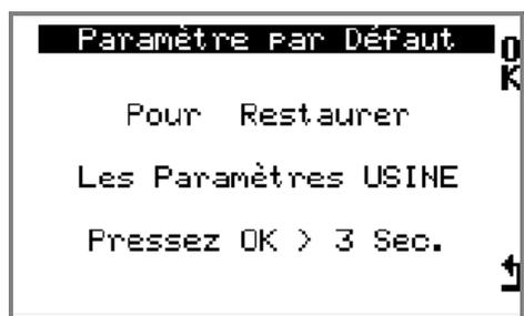
Restaure les paramètres d'usine, pressez 3 secondes sur « OK » pour lancer la procédure. **A noter** : cette procédure efface les circuits et les données enregistrées.
