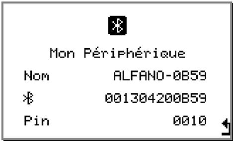
Une fenêtre apparaît avec les informations nécessaires pour la synchronisation de ces deux appareils. Introduisez ces données + le password personnel, configurable dans le « SETUP ».
